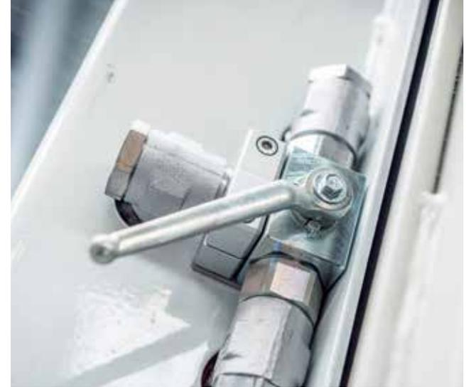
Die Umschaltung des Öldruckauftriebs auf die Etagen erfolgt über einen manuell betätigten Kugelhahn. Solide und störungsunempfindliche Technologie für maximale Einsetzbarkeit.
