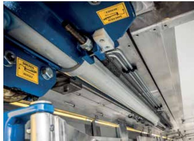
Durch das einzigartige eigene Berdex-Design können wir 1 zuverlässigen Zylinder verwenden. Bei weniger beweglichen Teilen und auch bei teilweisem Verschleiß arbeitet dieses System noch zuverlässig.
