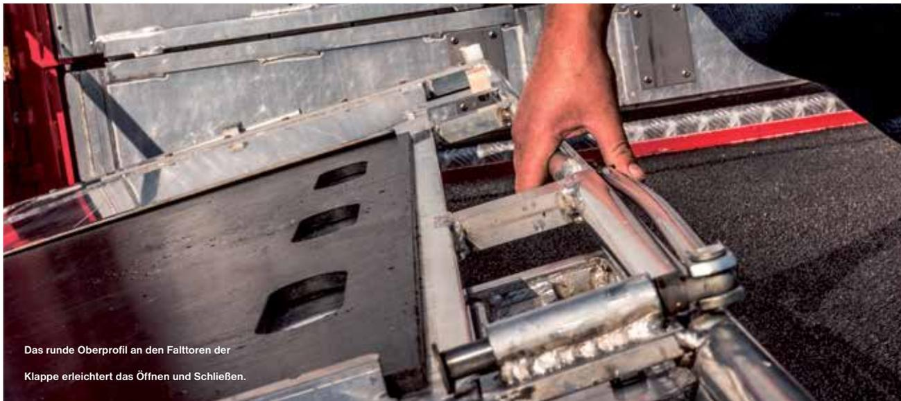
Das runde Oberprofil an den Falltoren der Klappe erleichtert das Öffnen und Schließen.
