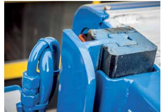
In der einzigartigen Berdex-Hebezeugkonstruktion mit Gleitschuhen wird die Anzahl der beweglichen Teile auf ein Minimum reduziert. Dies gewährleistet eine zuverlässige Einsetzbarkeit.
