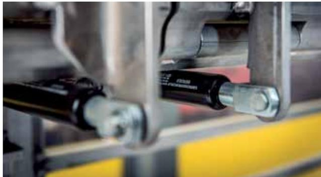
Leichte Bedienung der Klappbodenteile durch Gasfederunterstützung.
