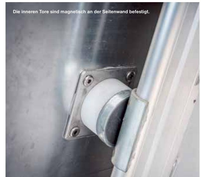
Die inneren Tore sind magnetisch an der Seitenwand befestigt.
