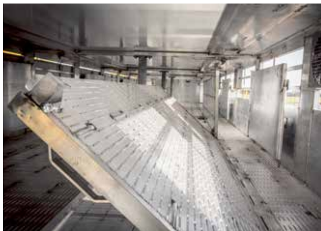
Een beweegbare vloer rust op het unieke Berdex klap T-profiel. Deze draagt over de hele lengte en is zaagsel en mest dicht.
