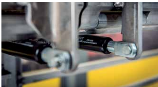
Lichte bediening van de klapvloerdelen door gasveer ondersteuning.
