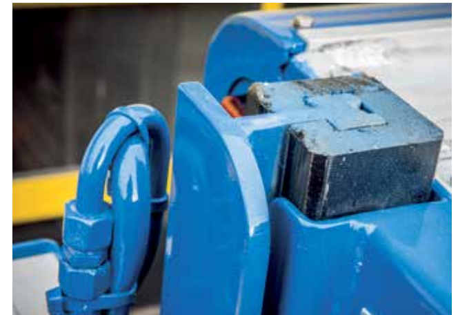
In het unieke Berdex laadlift ontwerp met glijblokken is het aantal bewegende delen tot een minimum beperkt. Dit zorgt voor een betrouwbare inzetbaarheid.
