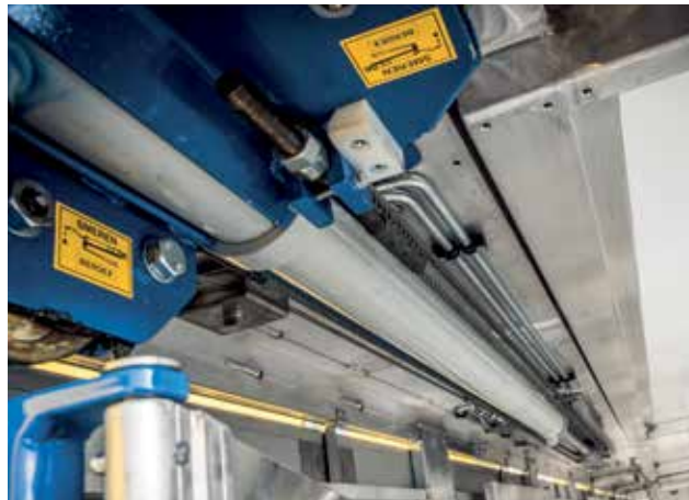
Door het unieke eigen Berdex ontwerp kunnen we gebruik maken van 1 bedrijfszekere cilinder. Minder bewegende delen en ook bij gedeeltelijke slijtage werkt dit systeem nog steeds betrouwbaar.
