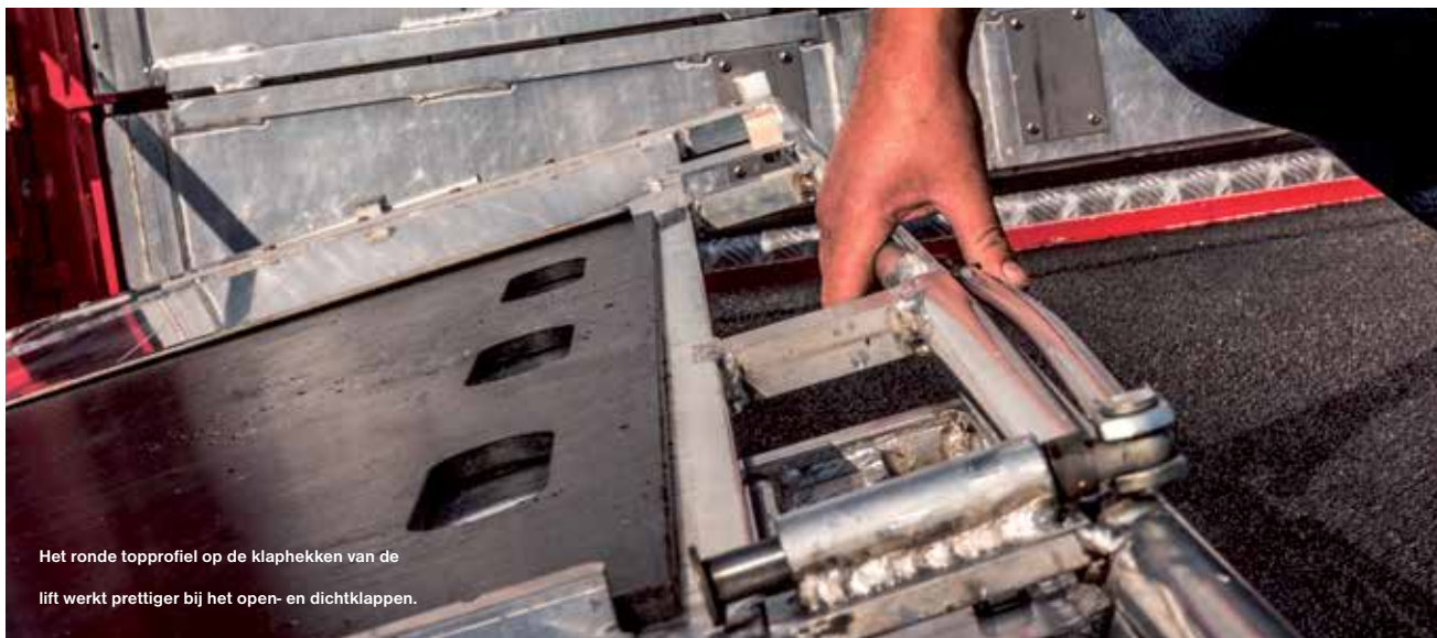
De binnenpoorten hebben een rond scharnier profiel en afgeronde zijanten om verwondingen te voorkomen. De ruimte voor de stalen sluitpen heeft een blinde afwatering. Om ook bij vorst een goede werking te garanderen.
