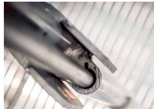
De binnenpoorten hebben een rond scharnier profiel en afgeronde zijanten om verwondingen te voorkomen. De ruimte voor de stalen sluitpen heeft een blinde afwatering. Om ook bij vorst een goede werking te garanderen.
